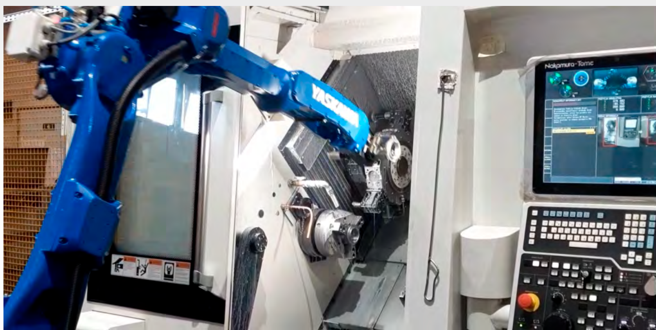
Integracja robota Motoman GP25-12 z maszynami Nakamura Tome WT-250II.
